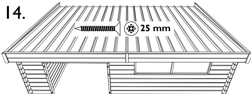
**NL:** Op de 2 voorste hoeken komen tot slot nog de L-profielen om de aansluiting van de frontale sierlatten te maskeren. Deze L profielen vormt u door 2 hoeksierlatten op versteek tegen elkaar te zetten en te vijzen met vijsjes van 25 mm. Bij de modellen met de FSLM in 2 delen, komt er nog een latje SSL daar waar de 2 delen FSLM samen komen
