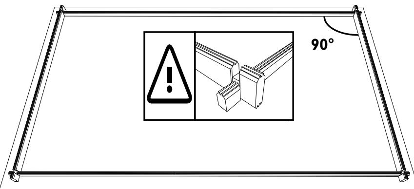
**NL:** Zorg ervoor dat u onmiddellijk  $90^\circ$  bekomt in uw hoekverbinding. De tand hoort bovenaan. De onderste plank in het voor- en achterpaneel is een halve lat met enkel een tand, de onderste plank van het zijpaneel heeft tand en groef. Zorg ervoor dat de planken mooi op de grond steunen.
