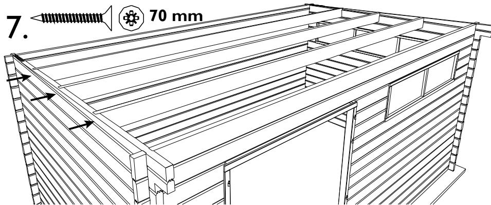
**NL:** Plaats de dakbalken P in de uitsparingen van de dakhellingen. Vijs elke dakbalk vast door de helling met 1 vijs van 70mm per kant (Het aantal dakbalken van uw blokhut kan afwijken t.o.v. de tekening).
