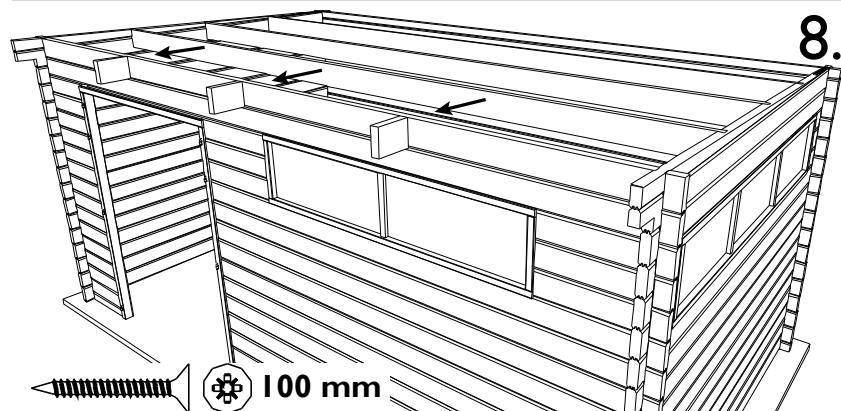
**NL:** Vijs de blokjes S44 telkens met 1 vijs van 100 mm door de zijwand vast in de kop van het blokje. Hou de onderkant van blokje gelijk met de onderkant van de oversteek vooraan. Verdeel de blokjes symmetrisch over de zijwand (het aantal blokjes van uw blokhut kan afwijken t.o.v. de tekening).
