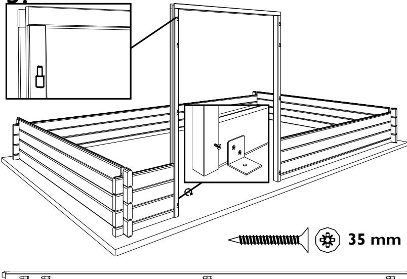
**NL:** Bouw verder op volgens de meegeleverde plaatjes (zie gedetailleerde onderdelenlijst) tot u ter hoogte van de onderkant van de ramen komt (sommige modellen hebben geen of slechts 1 raam). Plaats nu nog 1 laag extra. Laat het raamkozijn in de opening zakken. **Maak uw kader niet vast dmv schroeven of nagels aan uw beringing!** ("Hout leeft").
