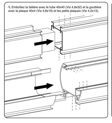
celle-ci afin que vous ayez une pente minimum de 10%, régler le niveau et fixer(Vis m6x50 et cheville m7x50). Hauteur de faitière de poteau Hauteur de faitière ≥ (10 x Profondeur de pergola : 100) + hauteur de poteau
