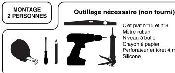
Clef plat n°15 et n°8 Mètre ruban Niveau à bulle Crayon à papier Perforateur et foret 4 mm Silicone
