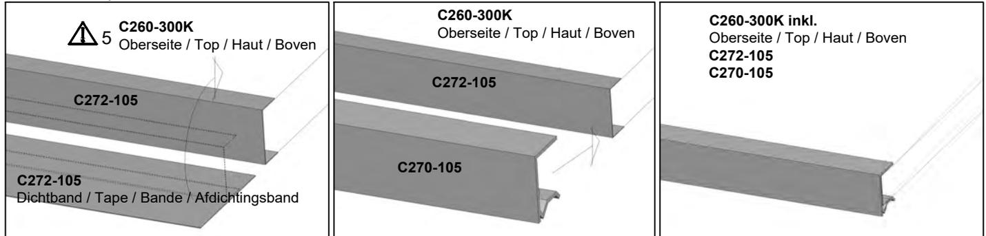
**Dachplatten verlegen** lay roof panels / lay de panneaux de toit / lag dakplaten
