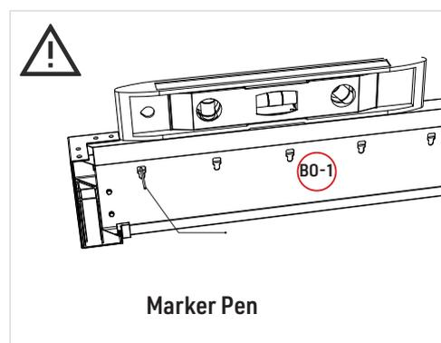
À l'aide de 2/3 personnes, en utilisant un niveau à bulle s'assurer que la poutre murale **BO-1** soit bien droite et avec un crayon marquer les trous de perçage, avant de retirer la poutre.
