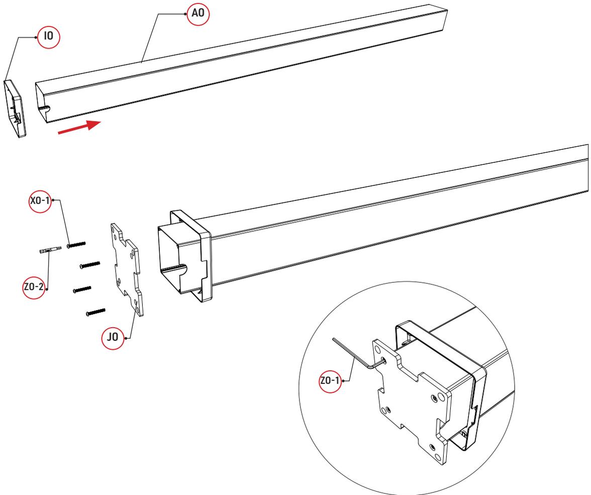
Glisser les caches **IO** sur les poteaux **AO**, en positionnant l'ouverture dans le même sens que l'ouverture située sur le poteau en forme de demi-lune.
