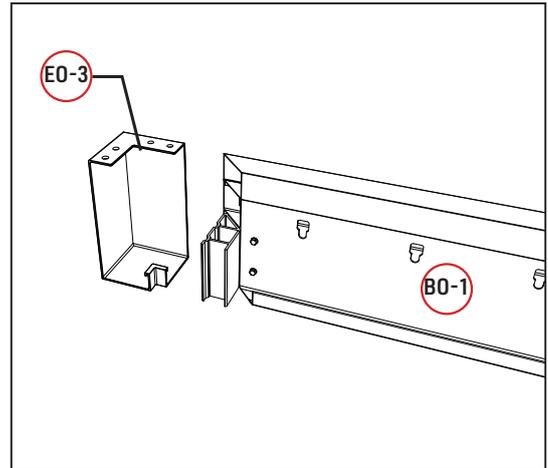
Sur un mur plat, positionner la poutre murale **BO-1** sur la façade à 237 cm de hauteur.
